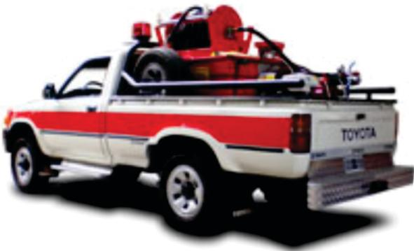
Equipo que se puede montar en todo tipo de Pickup de tracción simple o 4x4. Simple o doble cabina. Tanque de Agua de 600 litros en prfv, rotomoldeado o chapa. Motobombas forestales y devanadera de 25 mtrs con manga de 1" y lanza forestal.
